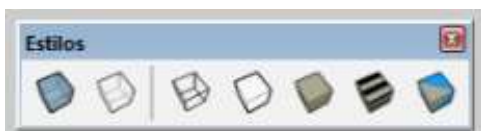
Barra “Estilos”: para mudar o estilo de visualização do modelo, possibilitando ver todas as arestas invisíveis, ver com transparência, ocultar arestas etc.
