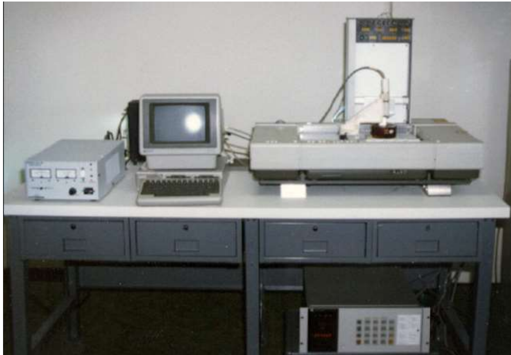
Figura 9- Primeira impressora 3D SLA – 1 (Fonte: Sculpteo)
