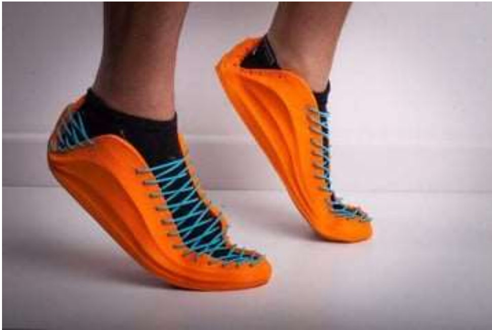
Figura 16- Sapatos imprimidos com material TPC
