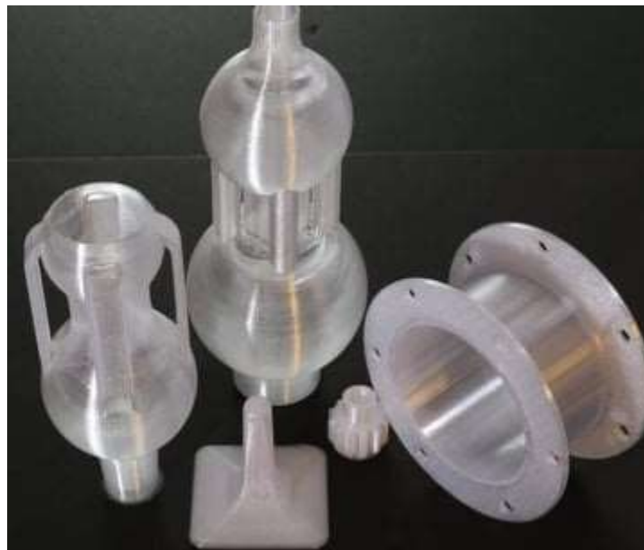
Figura 15-Peças impressas em PETG
