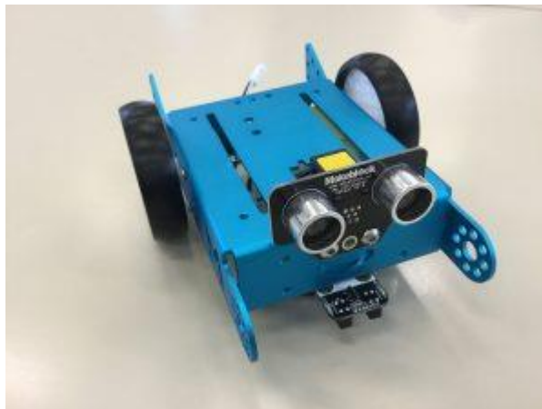
Figura 24- Montagem do sensor ultrassónico
